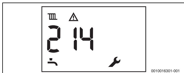
Fig. 77 Exemplu: defecțiune care nu determină blocare
